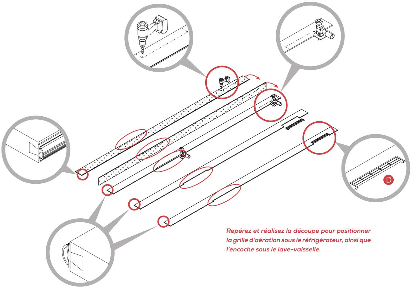
Repérez et réalisez la découpe pour positionner la grille d'aération sous le réfrigérateur, ainsi que l'encoche sous le lave-vaisselle.
